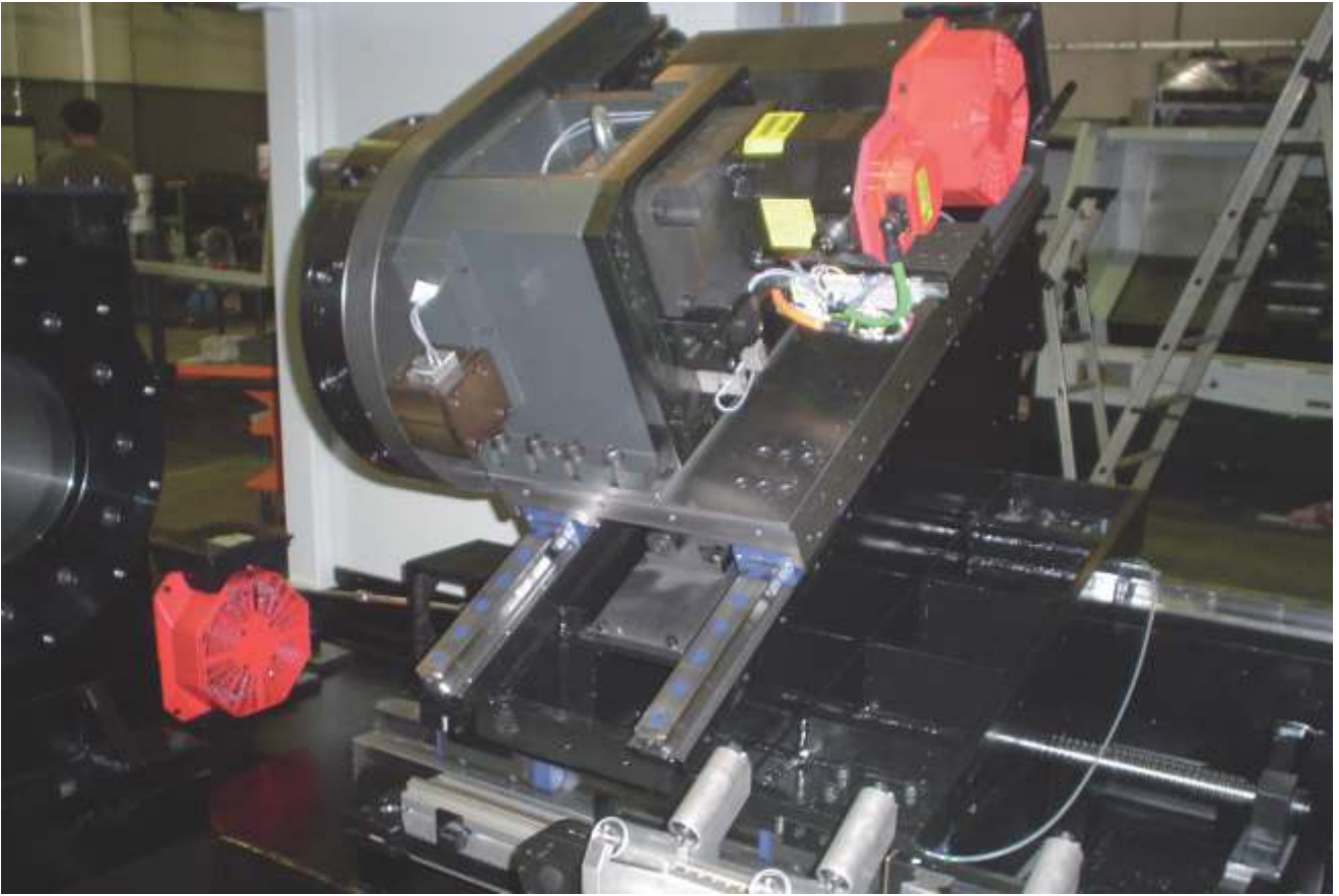
Monoguias MG 45 LC sobre o Torno CNC
